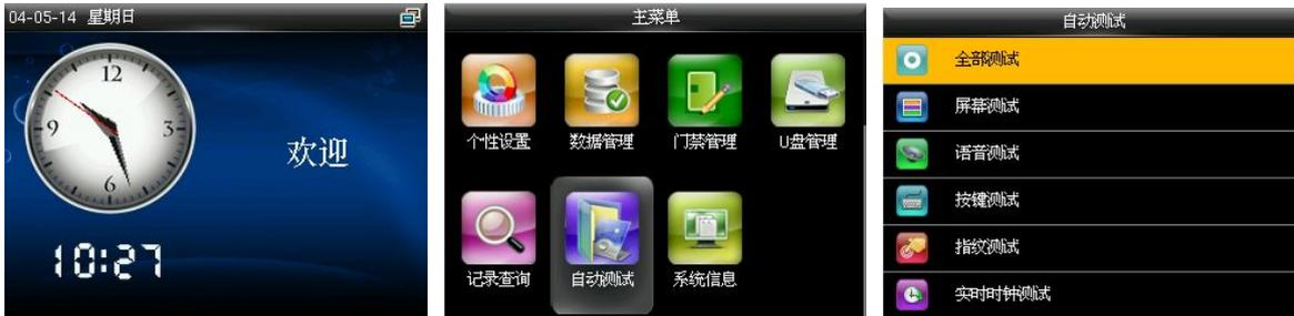
按 **M/OK** > 自动测试，进入**屏幕、语音、按键、指纹和实时时钟**测试界面。
